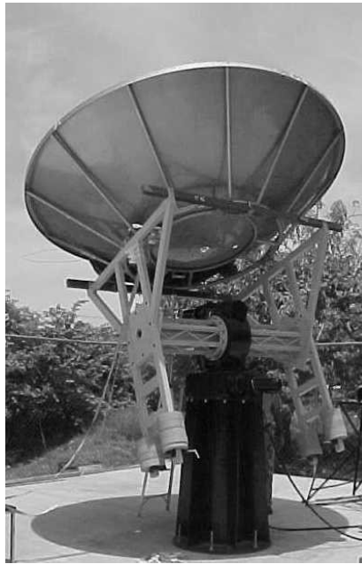
Figura 7. Ejemplo de concentrador solar con disco parabólico. Fotografía del COSPAA-90 en la plataforma de concentración del CIE-UNAM, México.
