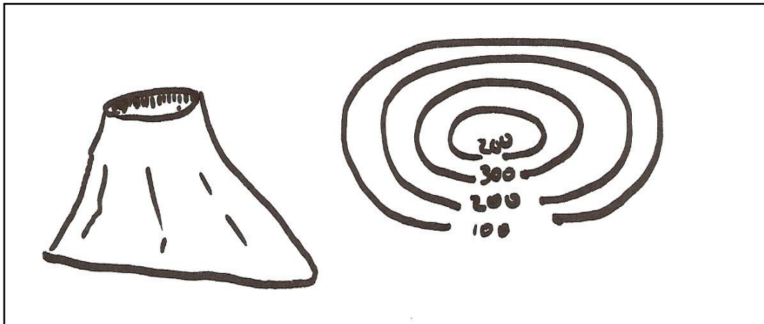
Figura 8. Representación de un volcán. Nótese que al llegar a la cima, las curvas de nivel comienzan a descender indicando la presencia de un cráter. (elaboración propia).
