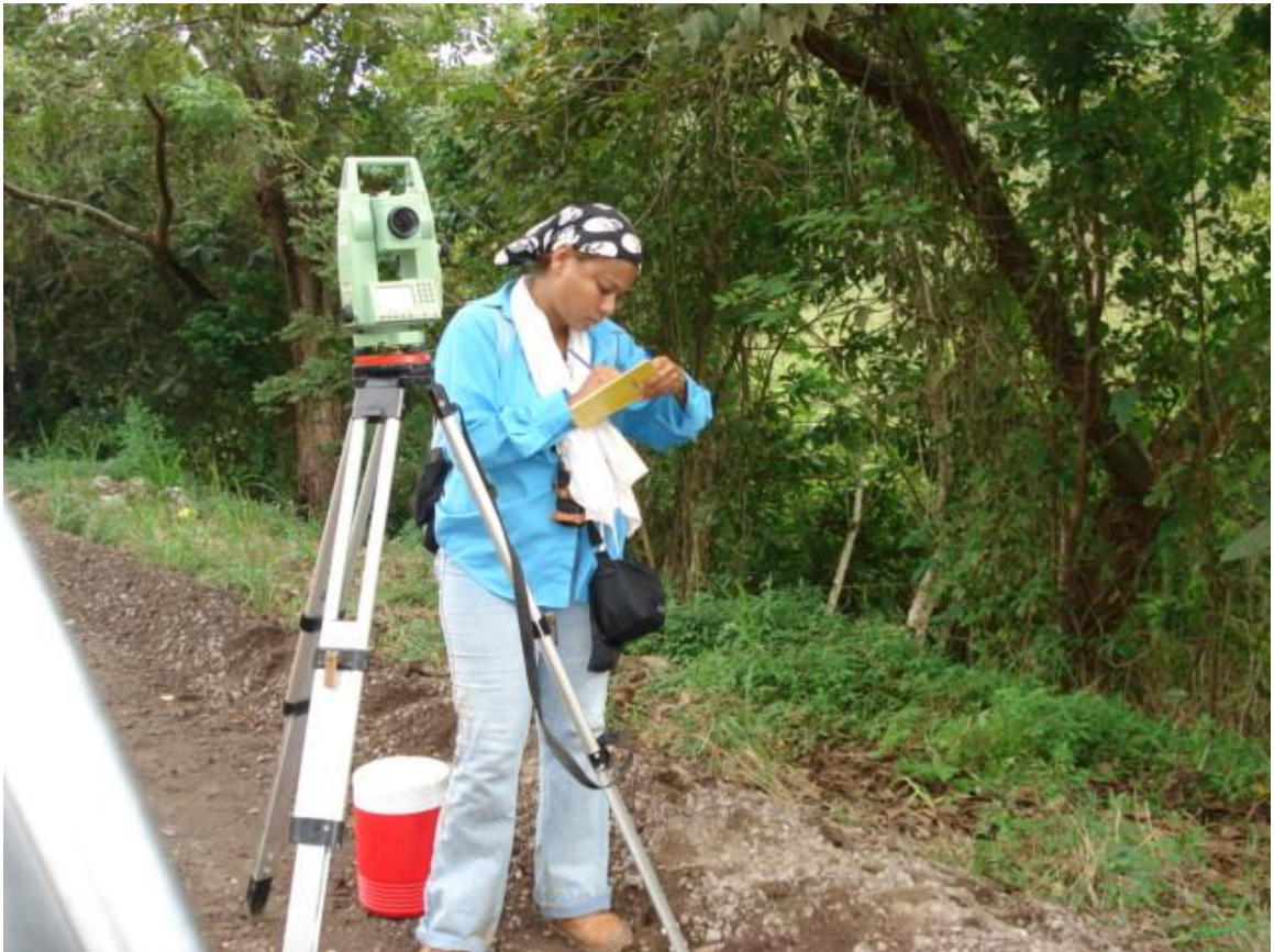
Figura 1. El geólogo hace las anotaciones y levantamiento topográfico para la evaluación de una futura carretera. (elaboración propia).
