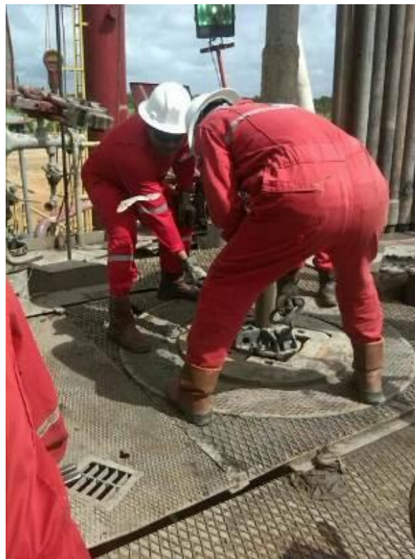
Foto# 3 Armado de BHA, fuente: Trabajo de campo, Fuente: Trabajo de Campo Taladro Troil 007- Campo Huyapari.
