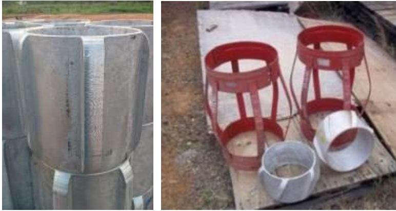
Foto #5 Centralizadores para Revestidor 13 3/8 Fuente: Trabajo de Campo en Taladro SSD 17, Campo Huyapai.
