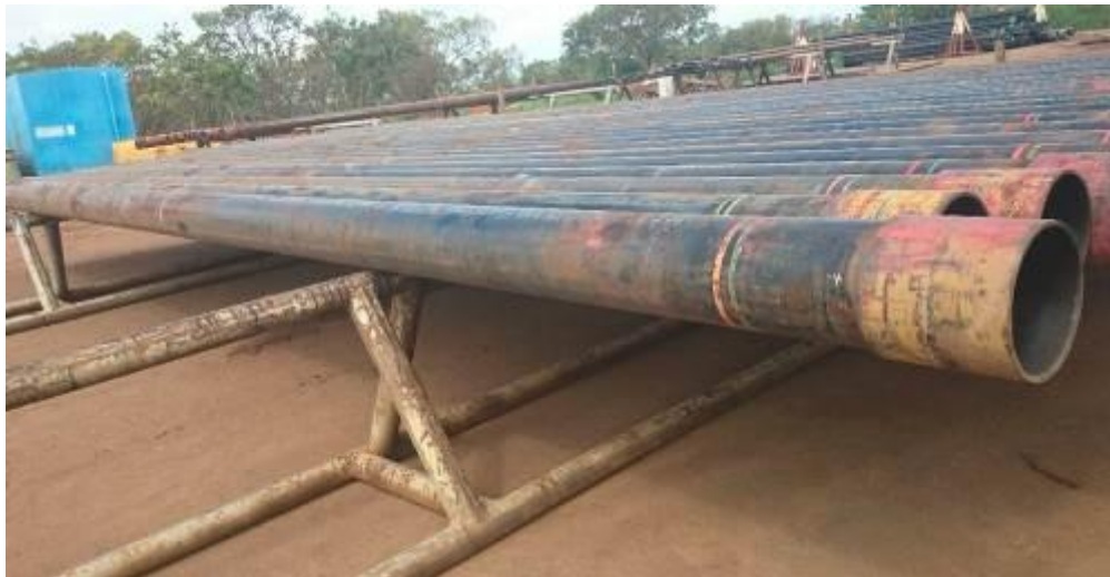
Foto # 4: Revestidores 13 3/8 API 117, Fuente: Trabajo de Campo Taladro SSD 17. campo Huyapari
