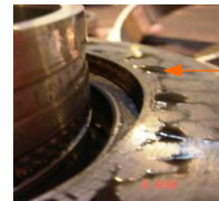
Figura 47 Cara intermedia, mostrando contaminación con aceite lubricante
