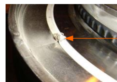
Figura 45 Parte trasera de la cara del sello intermedio, mostrando daños a los sellos polímeros
