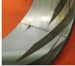
Figura 55 Fractura del sello primario
